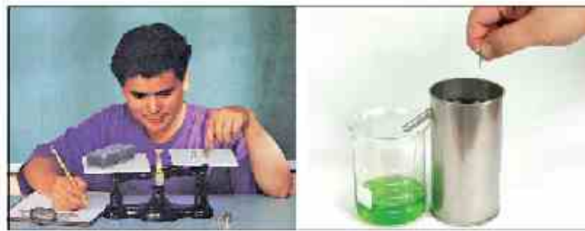
Fig. (10) Mesurer la masse volumique en utilisant une balance et une éprouvette graduée alors il résulte 2 erreurs dans la mesure
